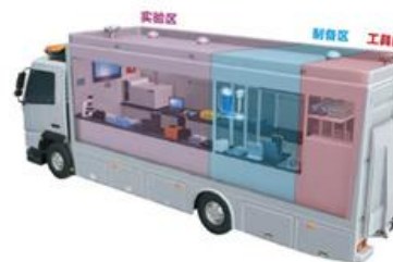
车载实验室仪器，包括 ICP-MS、ICP、LC- MS、IC、UV-Vis等， 创新减震和模块化设计
